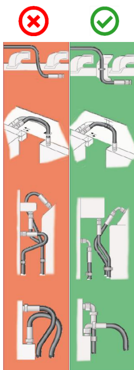
Fig. 9-23 – Positionnement des tuyaux
