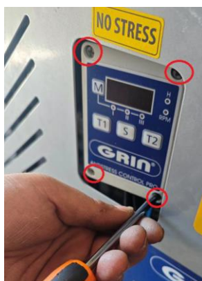
Fig. 9-2 – Boîte de l'unité de contrôle
