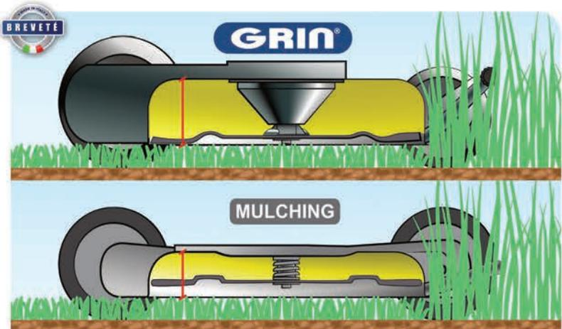
Le système de tonte Grin est composé d'une lame et d'un disque à hélice brevetés. La forme de la lame, les matériaux spéciaux employés dans sa construction ainsi que sa position spécifique conjuguée au disque à hélice permettent de créer des tourbillons d'air à l'intérieur du carter Grin.
