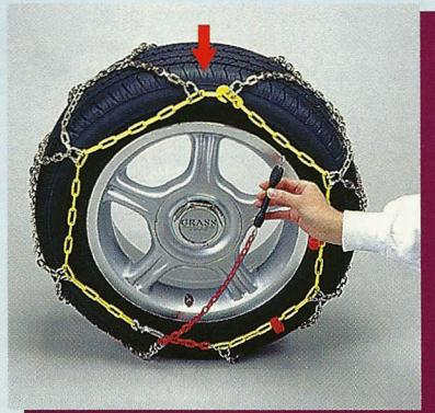
**D** Ring hinter dem Reifen hervorziehen und öffnen.
