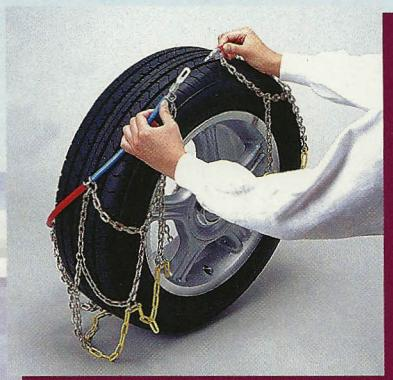
**D** Seitenkette schliessen. (Letztes gelbes Glied in gelben Haken einhängen.) Geschlossenen Ring hinter den Reifen führen. (Der Ring muss vollends hinter dem Reifen verschwinden.)
