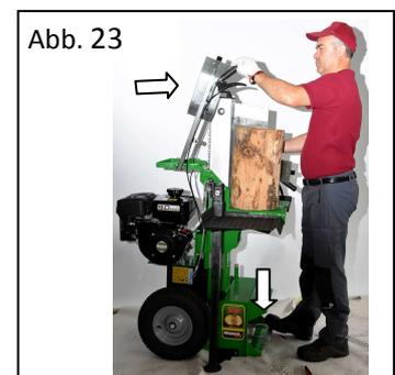
Bei weiterhin gedrücktem Pedal, die Hände vom Holzstück nehmen (das jetzt durch den Spaltkeil festgehalten wird) und damit die beiden Bedienungshebel (Abb. 24) gleichzeitig betätigen.
