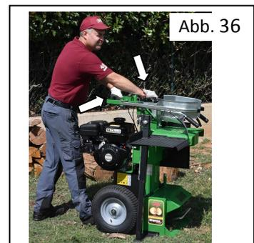
Das Gerät leicht kippen und zum Transport schieben. (Abb. 37)
