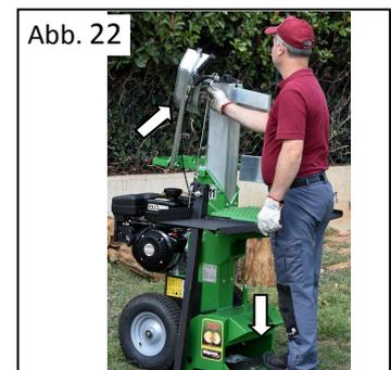
Der Spaltkeil fährt nach unten und hält an, sobald er mit dem Holz in Berührung kommt; bei dieser Bewegung erfolgt noch keine Spaltung.
