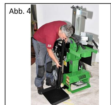
Die Struktur mit den entsprechenden mitgelieferten Schrauben befestigen, indem sie mit einem 13 mm Schlüssel auf der linken Seite des Tisches und der unteren Rahmenbasis festziehen. (Abb. 5)
