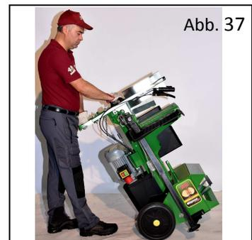
Um den Holzspalter anzuheben, muss er an der vorbereiteten Stelle (Abb. 38) mit einem für das Gewicht der Maschine geeigneten zertifizierten Ankerband oder direkt mit einem zugelassenen Haken verankert werden.
