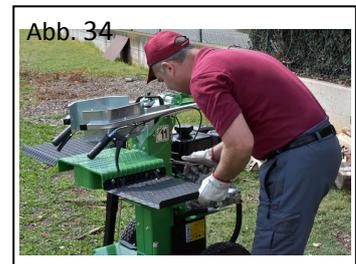
Beide Holzablagen senkrecht zum Holzspalter in den entsprechenden Fugen positionieren und die Schrauben mit dem 13 mm Schraubenschlüssel wieder festziehen. (Abb. 35)
