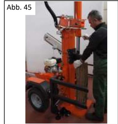
An dieser Stelle fährt das Spaltmesser nach unten bis auf Höhe des Stammstückes; das Holzstück wird auf diese Weise in der gewünschten Position blockiert, ohne dass bisher Spaltkraft entwickelt wurde.
