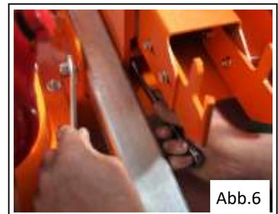
Entfernen Sie die Befestigungsmuttern des Stützrades. (Abb. 7)
