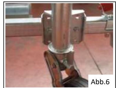
Die Höhe des vorderen Stützrades durch absenken bzw. anheben so regeln, dass die Zugdeichsel korrekt waagrecht ausgerichtet ist und das Gerät über ausreichende Stabilität verfügt. (Abb. 9)
