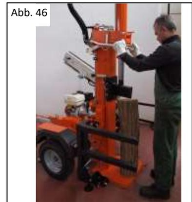
Die Maschine verfügt über zwei Spaltgeschwindigkeiten und einen Rücklauf. Die zweite Spaltgeschwindigkeitsstufe entspricht in etwa der Hälfte der Spaltleistung der ersten Geschwindigkeitsstufe (siehe Tabellen technische Daten und Abb. 49).
