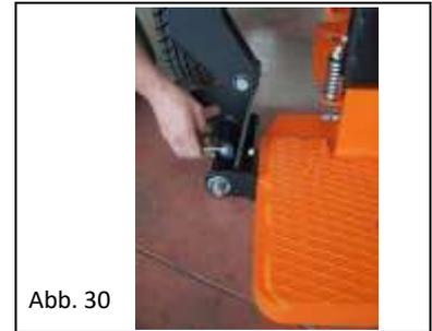
Der Stammheber selbst vom ersten position der Hakenhalterung entriegeln. (Abb. 33)
