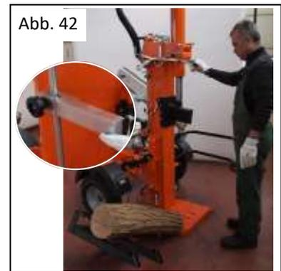
Das Gerät wurde für die Bedienung durch nur eine Person ausgelegt, die immer vor den Bedienungshebeln des Holzspalters stehen muss. (Abb. 45)
