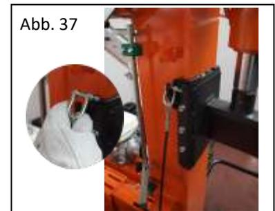
Um der Stammheber auf den Boden abzusenken, ihn aus dem Hakenblock lösen. (Abb. 40)
