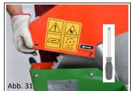
Die Oberabdeckung heben und zusammen mit der Wippe kippen bis es auf dem Boden aufliegt. (Abb. 32)
