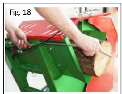
Réglez la poignée en dévissant les deux vis de verrouillage montées à l'avant de la bascule. (Image 19)
