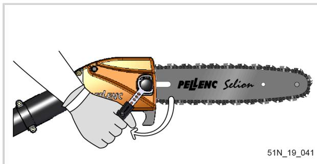
3. Positionner le levier de la clé télescopique (11) sur son aimant de maintien.
