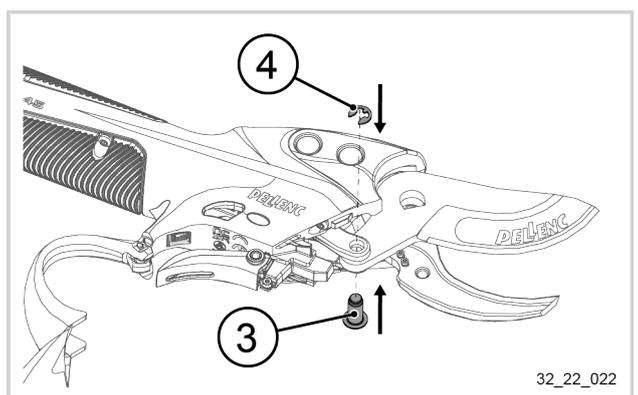
7. Die Abflachung des Klingenbolzens (5) mit der Positionierhilfe der Klinge (2) in Übereinstimmung bringen.
