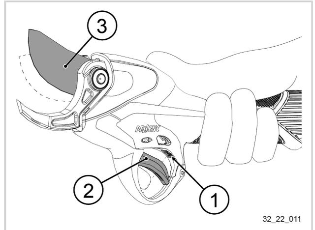
Bei dem Betriebsmodus mit halber Klingenöffnung bleibt die Klinge halb geöffnet, solange das optische System (4) den Finger vor dem Auslösehebel (2) erfasst. Sobald Ihr Finger sich vom Auslösehebel entfernt, steuert das optische System die volle Öffnung der Klinge (3) an.
