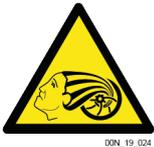
Sich nicht mit den Haaren dem Ansauggitter nähern. Einzugsgefahr der Haare in die Turbine.
