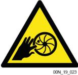
Keine Finger oder Gegenstände jeglicher Art in das Ansauggitter einführen. Wenn das Ansauggitter nicht eingebaut ist, besteht die Gefahr, mit den rotierenden Teilen in Berührung zu kommen. Verletzungsgefahr! Gefahr der Beschädigung der rotierenden Bauteile.
