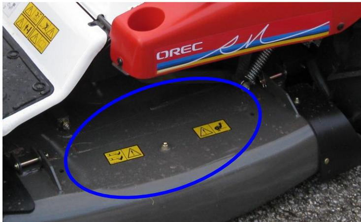
Attention à la courroie de transmission, retirer la clé de contact avant toute intervention
