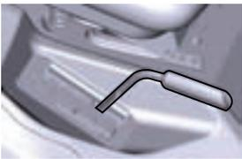
Der Hebel besitzt **7** Arbeitspositionen, die einer Schnitthöhe von **3 bis 9,5 cm** entsprechen.
