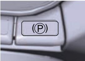
Die Feststellbremse hat zwei Stellungen. In der Stellung **eingedrückt** ist die Bremse nicht aktiviert. Nach dem **Hochziehen** und Treten des Bremspedals wird die Feststellbremse aktiviert (sie bremst).
