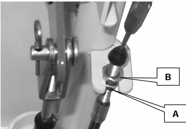
Lösen Sie die Sicherungsmutter (A) und ziehen Sie die Stellmutter (B) etwas fester an. Prüfen Sie das Ergebnis. Lässt sich der Fahrertrieb wieder ordnungsgemäß schalten, ziehen Sie die Sicherungsmutter (A) wieder fest an.
