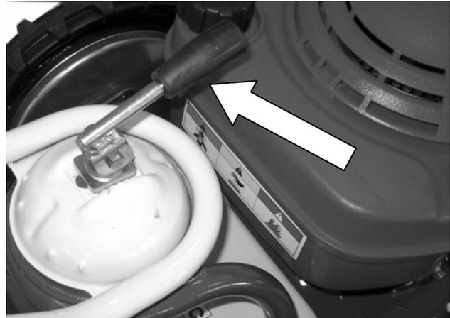
Zum Verstellen des Führungsholms wird der Befestigungshebel nach oben geklappt und ggf. durch drehen etwas gelöst. Nun kann der Holm in die gewünschte Position gebracht werden. Nun ziehen Sie den Befestigungshebel wieder an und klappen den Hebel wieder nach unten. Achten Sie darauf, dass die Verzahnung des Holms in die Verzahnung der rechteckigen Scheibe unter der Befestigungsschraube eingreift.
