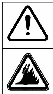
Feuergefahr. Kraftstoff nicht bei heißem Motor einfüllen. Darauf achten, dass kein Benzin verschüttet wird. Beim Umgang mit der Maschine nicht rauchen! Beim Umgang mit Kraftstoff ist besondere Sorgfalt geboten.
