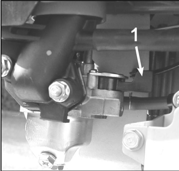
Bei Nichtgebrauch der Maschine wird der Benzinahn (1) verschlossen. Drehen Sie ihn hierzu nach hinten. Zum Öffnen des Benzinahns drehen Sie ihn nach vorn.
