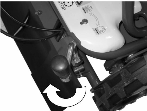
Drehen Sie den Hebel für die Schnitthöhenverstellung im Uhrzeigersinn, um die Schnitthöhe zu verringern. Drehen Sie gegen den Uhrzeigersinn, um die Schnitthöhe zu erhöhen.
