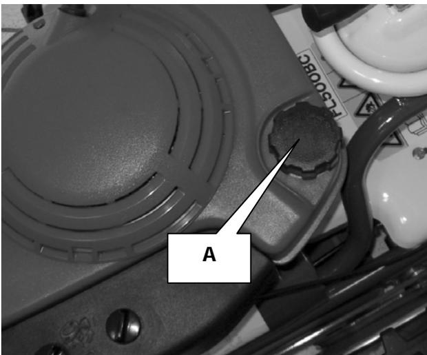
Überprüfen Sie vor jedem Start des Motors, ob der Kraftstofftank verschlossen ist. Wischen Sie verschütteten Kraftstoff vom Gerät ab. Achten Sie beim Tanken darauf, dass kein Feuer, Glut oder elektrische Funken in der Nähe sind. Beim Betanken herrscht absolutes Rauchverbot. Betanken Sie das Gerät niemals, solange der Motor noch heiß ist. Lassen Sie den Motor vor dem Betanken abkühlen.
