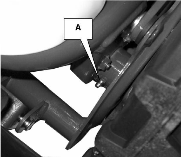
Schmieren Sie die Achsen der Hinterräder am Schmiernippel (A) mit Fett.
