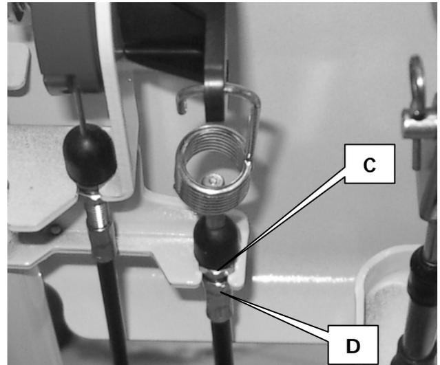
Lösen Sie die Sicherungsmutter (D) und ziehen Sie die Stellmutter (C) etwas fester an. Prüfen Sie das Ergebnis. Lässt sich der Fahrertrieb wieder ordnungsgemäß schalten, ziehen Sie die Sicherungsmutter (D) wieder fest an.
