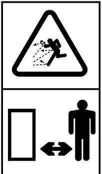
Vorsicht: Im Betrieb können Fremdkörper aus dem Mähergehäuse geschleudert werden. Dritte während des Mähbetriebes fernhalten.
