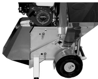
7. Stecken Sie den Vierkantschlüssel zum Spannen des Keilriemens auf die Aufnahme an der rechten Seite.
