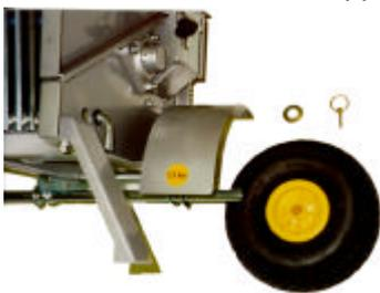
4. Montieren Sie die Standfüße und den hinteren Auswurfkanal an der dem Schneidwerk zugewandten Seite unter dem Gerät. Achten Sie darauf, daß Sie auch die Querstrebe zwischen den Standfüßen anbringen.
