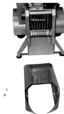
6. Lösen Sie die Sicherheitsschraube auf der rechten Seite am Gerät. Ziehen Sie die Sicherheitsabdeckung heraus und befestigen an diesen Punkten den Seitentrichter.
