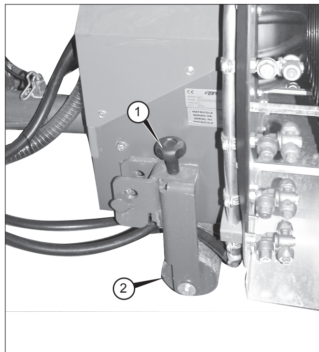
Fig. 15 - Réglage de la hauteur du ventilateur
