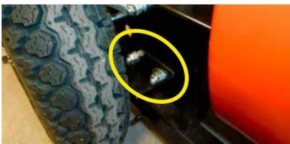
Si le boîtier de la turbine est trop bas dans sa position la plus basse et qu'il frôle le sol, il est possible de régler la hauteur de l'essieu avant en desserrant les deux vis de fixation.
