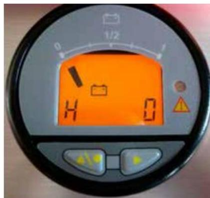
En appuyant sur le bouton de commande gauche, la tension de la batterie peut être affichée en volts, un affichage en % n'est pas possible du fait de la gestion propre de la batterie PELLENC !
