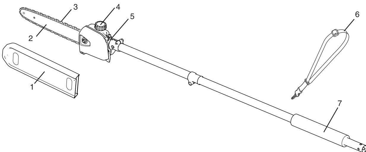
1. **Carter protettivo della barra guida** - Consente di coprire la barra guida e la catena durante il trasporto o lo stoccaggio. Rimuovere il carter protettivo della barra guida prima di utilizzare l'unità.
