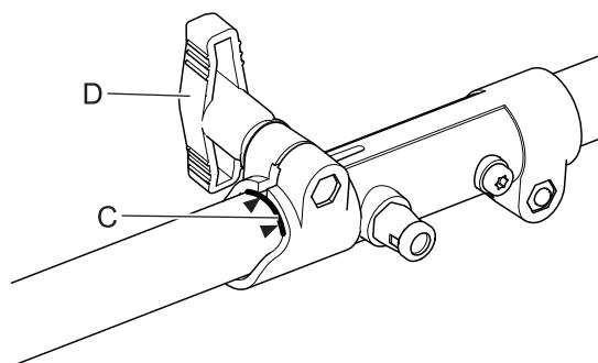
4. Innestare con cautela il gruppo albero motore nell'accoppiatore (B) fino alla decalcomania (C), prestando attenzione che l'albero motore inferiore interno si innesti correttamente nell'attacco quadro dell'albero motore superiore.
