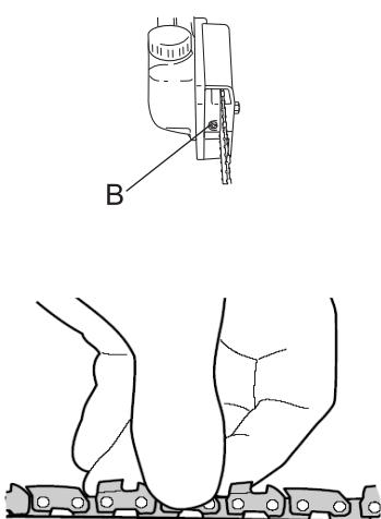
3. Levante el extremo de la barra guía mientras gira el tornillo tensor de la cadena (B).
