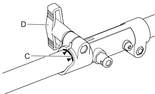
4. Insérer soigneusement l'arbre de transmission de l'outil dans le coupleur (B) jusqu'à la ligne d'assemblage tracée sur l'étiquette (C), en vérifiant que l'arbre de transmission inférieur intérieur s'enclenche dans la prise à carré conducteur de l'arbre de transmission supérieur.
