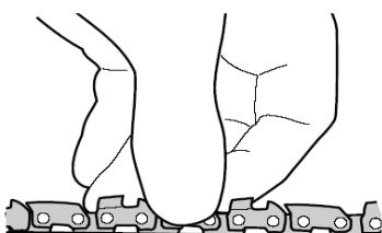
3. Durante la rotazione della vite di tensionamento catena (B), sollevare la punta della barra di guida.
