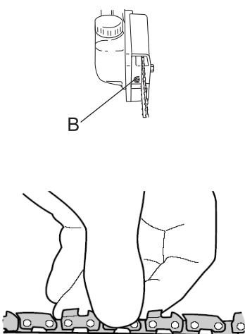
3. Lever le nez du guide-chaîne tout en tournant la vis de tension de la chaîne (B).
