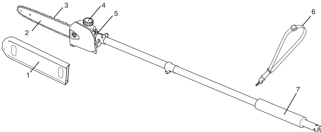
1. **Protecteur de guide-chaîne** - Sert à couvrir le guide-chaîne et la chaîne coupante durant le transport et l'en-treposage. Retirer le protecteur de guide-chaîne avant d'utiliser l'appareil.
