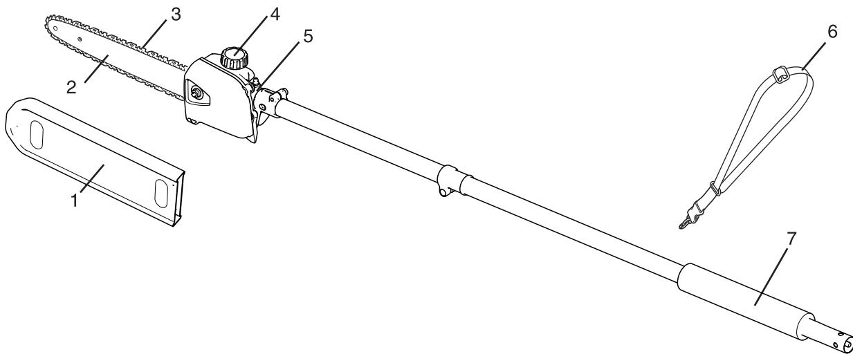
1. **Tapa de barra guía** - Se utiliza para cubrir la barra guía y la cadena de la sierra durante el transporte y almacenaje. Retire la tapa de la barra guía antes de usar la unidad.
