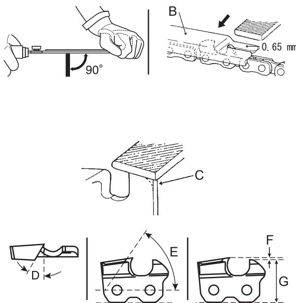
2. Halten Sie die Feile im Schneidzahn waagerecht, und feilen Sie in eine Richtung.
