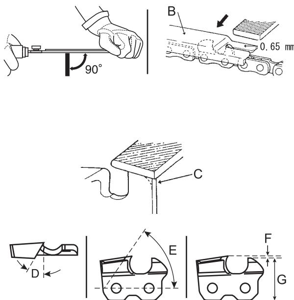
2. Maintenir la lime en position horizontale dans la lame et limer dans un sens.
