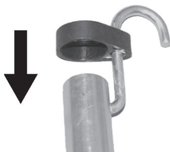
1. Insérer l'extrémité fine du crochet dans le trou de positionnement de l'arbre de l'outil.
