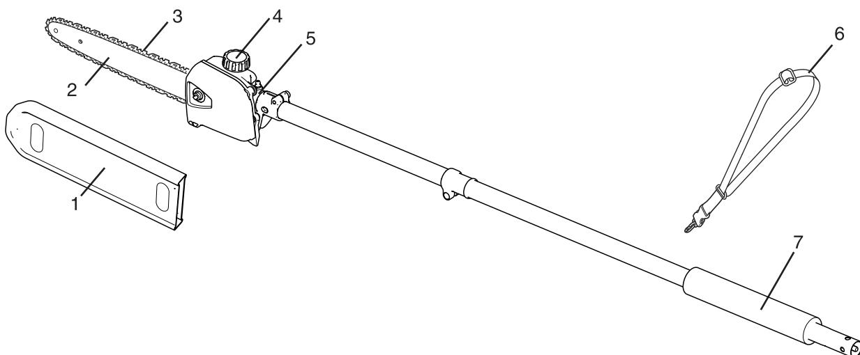
1. **Schwertabdeckung** - Dient zum Abdecken von Schwert und Sägekette bei Transport und Lagerung. Entfernen Sie die Schwertabdeckung, bevor Sie das Gerät verwenden.
