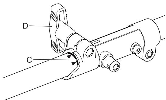
4. Coloque con cuidado el conjunto del eje de transmisión en el acoplador (B) para adherir la línea de montaje (C), asegurándose que el eje de transmisión inferior interior se acopla en el casquillo cuadrado del eje de transmisión superior.
