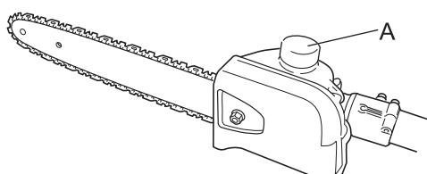
1. Coloque la unidad sobre una superficie nivelada y limpia con el tapón de llenado de aceite (A) mirando hacia arriba. Limpie los restos en el tapón de aceite y alrededor del cuello de llenado de aceite.
