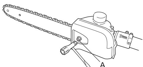
1. Legen Sie das Gerät auf einer sauberen, ebenen Fläche ab. (Schalten Sie für eine Einstellung während des Betriebs das Gerät aus, und entnehmen Sie den Akku. Warten Sie, bis das Schwert und die Kette abgekühlt sind, bevor Sie mit dem Einstellverfahren fortfahren.)
