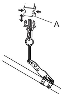
1. Accrocher le crochet de la sangle sur la fixation du tube extérieur.
