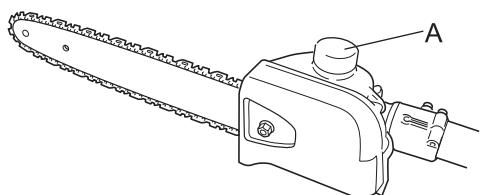
1. Placer l'appareil sur une surface plane et propre, le bouchon de remplissage d'huile (A) orienté vers le haut. Essuyer tout débris présent sur le bouchon d'huile et autour du goulot de remplissage d'huile.
