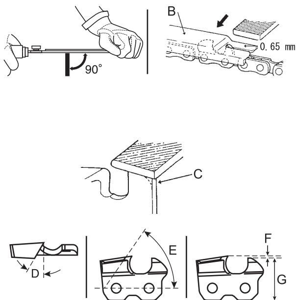
2. Mantenga la lima horizontal en la cuchilla y lime en una dirección.
