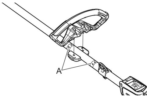
Richten Sie den Griff in eine für das Arbeiten bequeme Position aus, und ziehen Sie die Bolzen fest.
