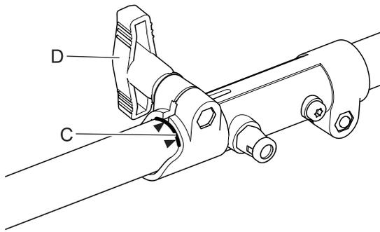
4. Insérer soigneusement l'arbre de transmission de l'outil dans le coupleur (B) jusqu'à la ligne d'assemblage tracée sur l'étiquette (C), en vérifiant que l'arbre de transmission inférieur s'enclenche dans la prise à carré conducteur de l'arbre de transmission supérieur.
