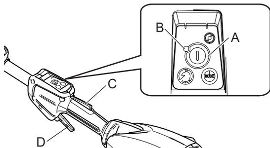
1. Suelte el interruptor de gatillo y el bloqueo del interruptor de gatillo y permita que el cabezal del accesorio se detenga.
