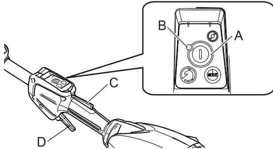
1. Relâcher l'interrupteur à poussoir et le blocage de l'interrupteur à poussoir, et laisser la tête d'outil s'arrêter.
