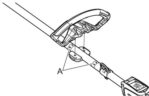
Orienter la poignée dans une position d'utilisation confortable, puis serrer les vis.
