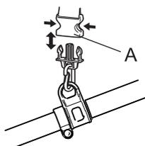
1. Accrocher le crochet de la sangle sur la fixation du tube extérieur.
