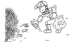
Puede producirse un accidente o lesión grave si sustancias extrañas rebotan en el accesorio de corte o si salta un cable u otro material enrollado alrededor del producto.
