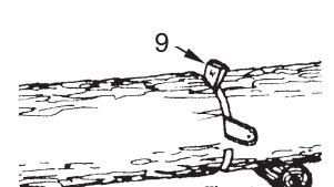
Realice un corte en ángulo, cuando una sección pueda apoyarse contra la otra.
