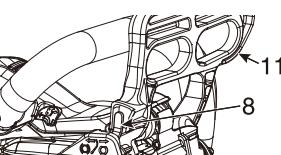
11. Protección de la mano delantera (palanca del freno)
