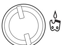
Tappo del serbatoio del lubrificante per catene
