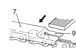
7. El control de la profundidad determina el grosor de las astillas producidas y deberá mantenerse correctamente durante toda la vida útil de la cadena.
