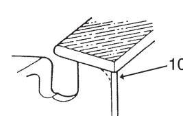
11. La conexión de accionamiento sirve para eliminar el serrín de la ranura de la barra guía. Por lo tanto, mantenga afilado el extremo inferior de la conexión de accionamiento.
