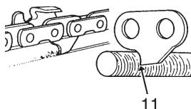
Une fois l'affûtage de la chaîne terminé, la tremper dans l'huile et nettoyer les dépôts de limaille d'affûtage avant utilisation.
