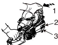
1. Lösen der Kettenbremse
