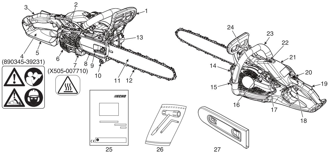
1. **Protezione paramani anteriore** - Situata tra l'impugnatura anteriore e la catena della motosega, protegge la mano e consente di controllare la motosega nel caso in cui la mano dovesse scivolare dall'impugnatura. Questa protezione viene utilizzata per attivare il freno che arresta la rotazione della catena.
