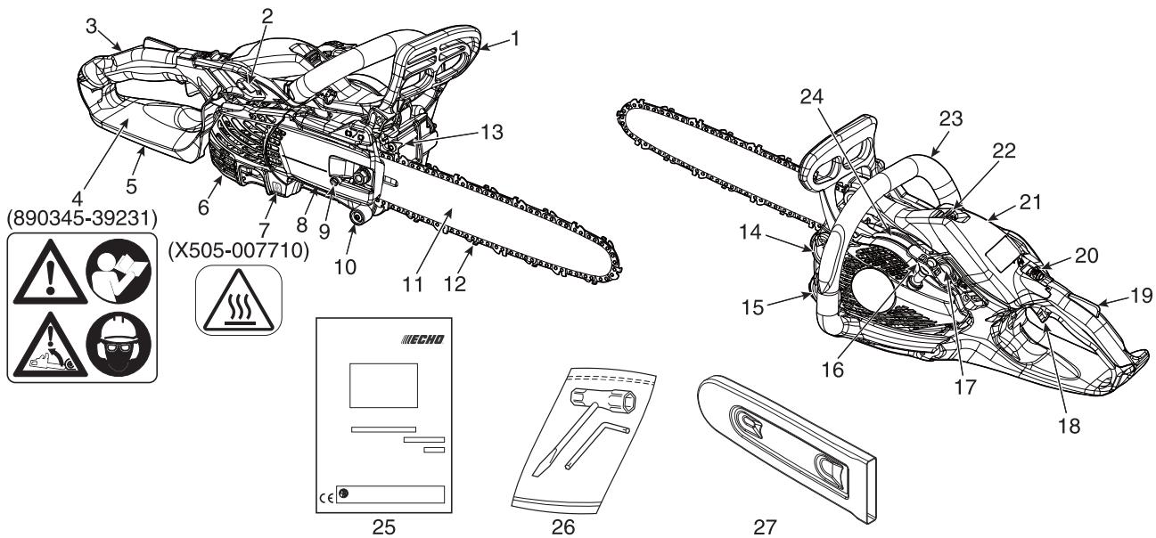
1. **Vorderer Handschutz** - Schutz zwischen vorderem Handgriff und der Sägekette, um die Hand vor Verletzungen zu schützen und die Maschine zu kontrollieren, wenn die Hand vom Griff abrutscht. Dieser Schutz wird verwendet, um die Kettenbremse zu aktivieren und die Kettenrotation zu stoppen.
