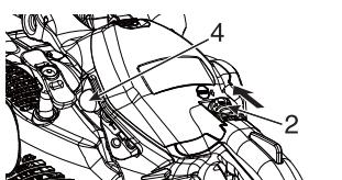
2. Interruptor de encendido (en funcionamiento)
