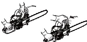
1. Bloquee la cadena: presione la protección para la mano delantera hacia adelante.
