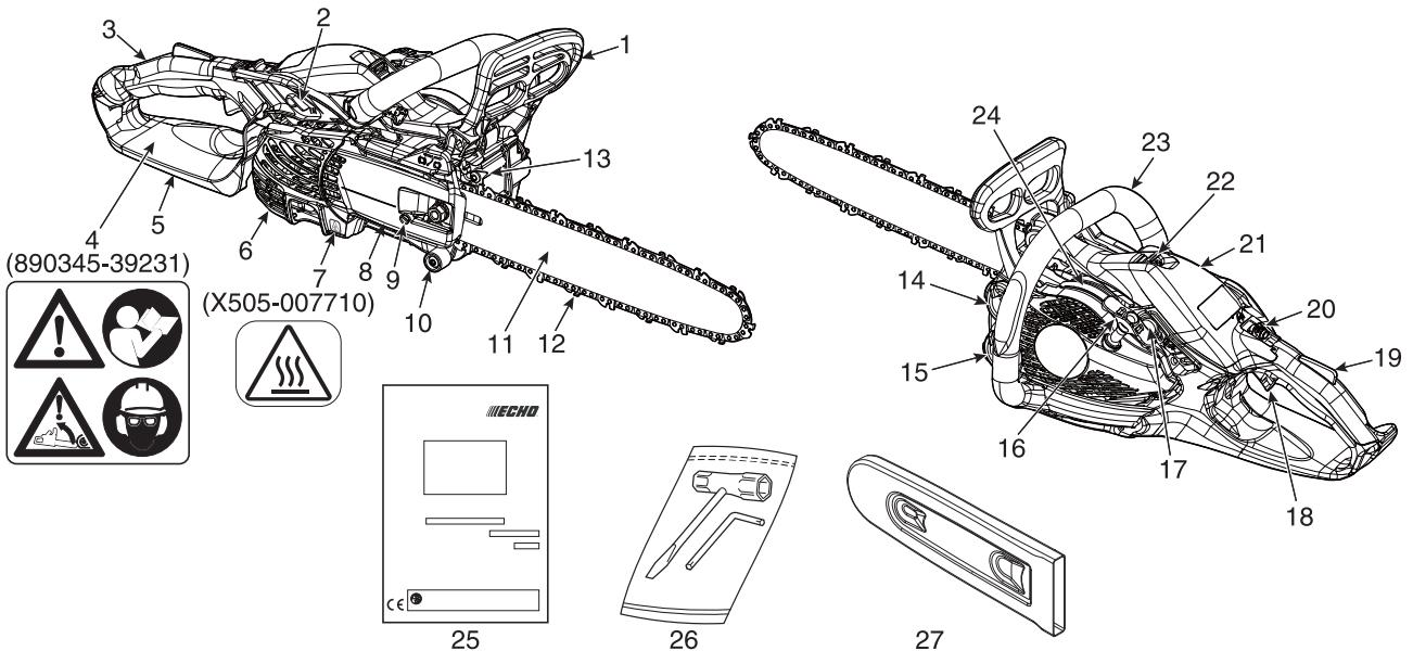
1. **Protège-main avant** - protection placée entre la poignée avant et la chaîne pour protéger la main contre les blessures et conserver la maîtrise de la tronçonneuse si la main glisse de la poignée.
