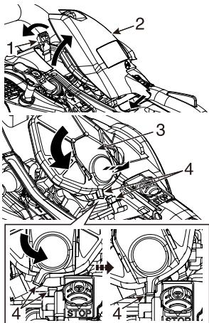
1. Verriegelung Luftfilterabdeckung      2. Luftfilterabdeckung      3. Luftfilter
