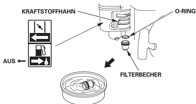
3. Den O-Ring in den Kraftstoffhahn einsetzen, und den Ablagerungsbecher anbringen. Den Ablagerungsbecher fest anziehen.
