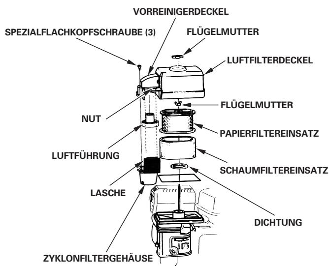
5. Bei Wiederverwendung die Luftfiltereinsätze reinigen.
