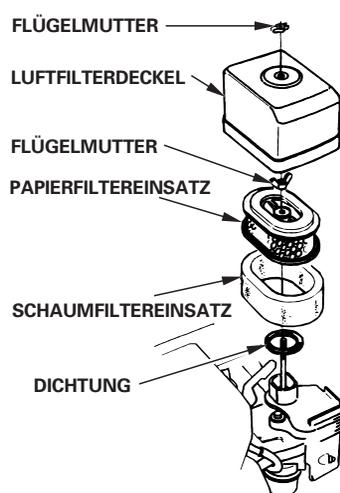
7. Schmutz von der Innenseite des Luftfiltergehäuses und -deckels mit einem feuchten Lappen abwischen. Darauf achten, dass kein Schmutz in den zum Vergaser führenden Luftkanal gelangt.
