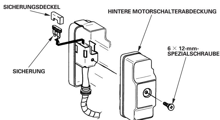
Häufiger Sicherungsausfall ist gewöhnlich ein Anzeichen für einen Kurzschluss oder eine Überlastung in der Elektrik. Falls die Sicherung häufig durchbrennt, bringen Sie den Motor zur Reparatur zu einem Honda-Wartungshändler.
