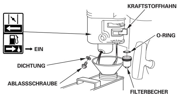
3. Nachdem der Kraftstoff restlos in den Behälter abgelassen worden ist, Ablassschraube, Dichtung, Ablagerungsbecher und O-Ring wieder anbringen. Ablassschraube und Ablagerungsbecher sicher anziehen.
