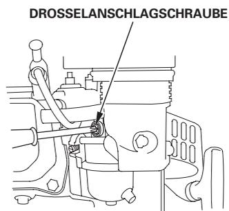
Sollleerlaufdrehzahl:  $1.400^{+200}_{-150} \text{ min}^{-1} \text{ (U/min)}$
