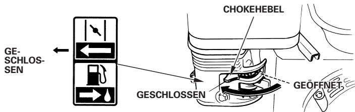
Zum Starten des Motors in warmem Zustand den Choke-Hebel auf OPEN (GEÖFFNET) gestellt lassen.
