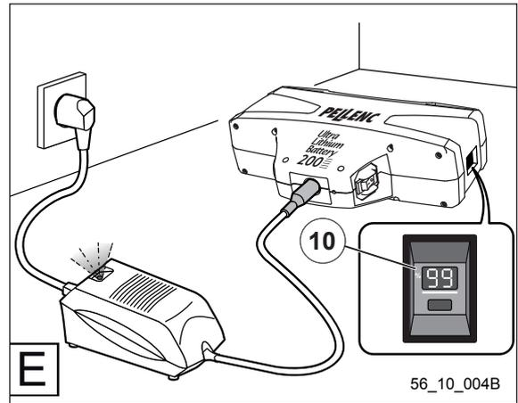
F. Une fois la batterie chargée, débrancher **en premier** le cordon de charge (15) au niveau de la batterie, et ensuite la prise secteur du chargeur (14).
