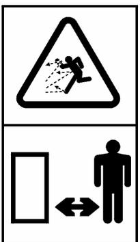
Vorsicht: Im Betrieb können Fremdkörper aus dem Mähergehäuse heraus geschleudert werden. Dritte während des Mähbetriebes fernhalten.
