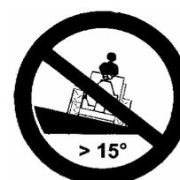
Beim Mähen an Hängen ist besondere Vorsicht geboten. Die Maschine darf nur bis zu einem Neigungswinkel von 15° eingesetzt werden. Sturzgefahr!
