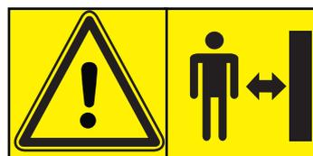
Vorsicht: Im Betrieb können Fremdkörper aus dem Mähergehäuse heraus geschleudert werden. Dritte während des Mähbetriebes fernhalten.
