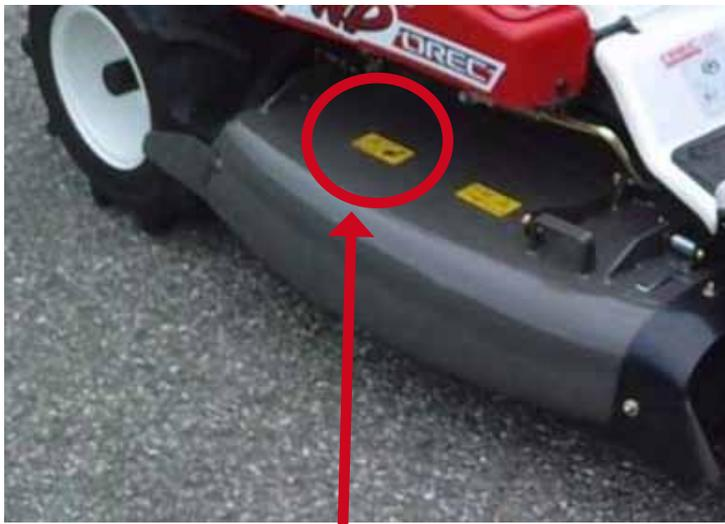
Achtung Keilriemenantrieb Quetschgefahr
