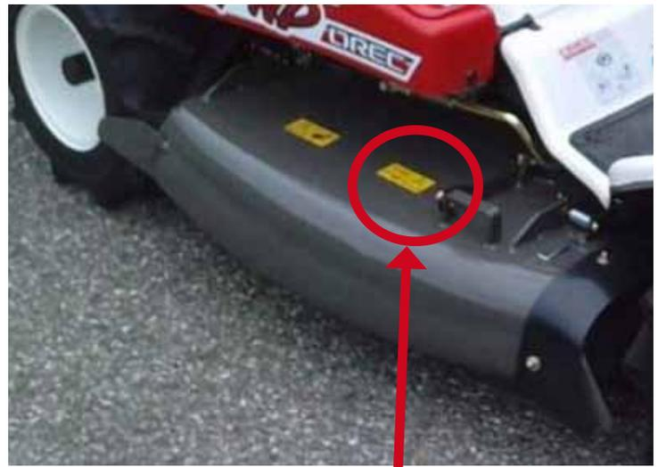
Bei laufendem Motor unter keinen Umständen mit der Hand oder anderen Körperteilen unter den Rand oder unter das Mähergehäuse kommen
