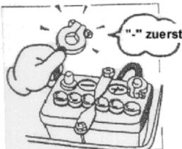
Lösen Sie die Verschraubung des Batteriehalters und entnehmen Sie die Batterie. Halten Sie die Batterie dabei immer aufrecht und gerade
