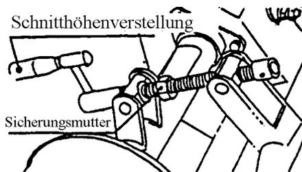
Stellen Sie die Schnitthöhe bei ausgeschaltetem Motor ein und befestigen Sie die Sicherungsmutter.
