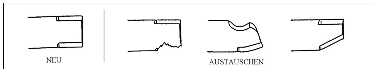
**Tip:** Wenn die Maschine auf trockenem oder sandigem Boden verwendet wird, nutzen sich die Messer schneller ab.
