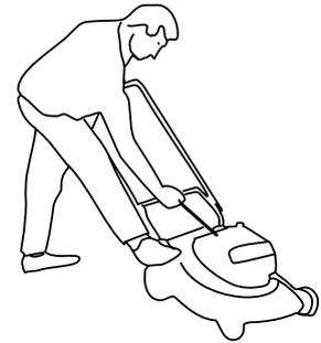
Versuch den Startergriff langsam zurück in seine Ausgangsposition. Motoren mit Kaltstarteinrichtung kurz warm laufen lassen und dann den Gashebel von CHOKE auf die gewünschte Drehzahl einstellen.
