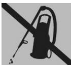
Pulire a fondo il tagliabordi dopo l'uso. Per la pulizia non utilizzare dispositivi ad alta pressione o getti d'acqua! Rimuovere meccanicamente i residui di taglio solo con una spazzola / scopetta.
