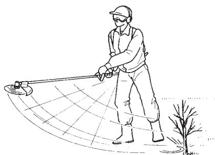
Rotation dans le sens inverse des aiguilles d'une montre 1. Poussée 2. Traction
