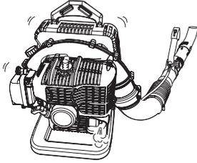
1. Sobald der Motor läuft, lassen Sie ihn 2 bis 3 Minuten im Leerlauf (niedrige Drehzahl) warmlaufen.
