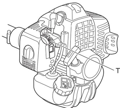
Chaque appareil est testé en usine et le carburateur est réglé avec précision pour offrir un niveau de performance optimal. Avant de régler le carburateur, nettoyer ou remplacer le filtre à air, démarrer le moteur et le laisser tourner quelques minutes pour qu'il atteigne sa température de fonctionnement.
