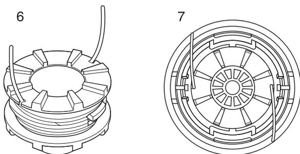
6. Lorsque le fil est entièrement enroulé autour de la bobine, accrocher ses deux extrémités dans les encoches correspondantes de la bobine pour le bloquer provisoirement ; laisser environ 10 cm de fil dépasser des encoches.
