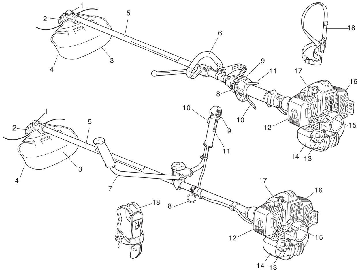
1. **Renvoi d'angle.** Avec deux engrenages pour changer l'angle de l'axe de rotation.
