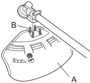
1. Placer le protecteur d'outil (A) sur la zone de fixation du renvoi d'angle et serrer 4 boulons (B).
