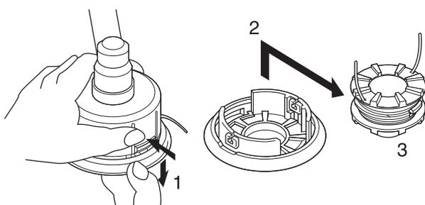
1. Comprimer les « ergots de fixation » (en deux endroits) vers l'intérieur, puis retirer le couvercle. Il est plus facile de les retirer l'un après l'autre.
