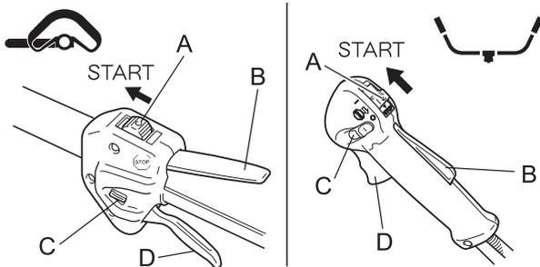
1. Placer l'interrupteur marche/arrêt (A) en position Marche (Start).
