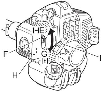
5. Placer la manette de starter (F) en position « Démarrage à froid » (Cold Start) (E).
