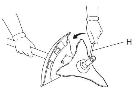
1. Examiner les lames (C) avant de les installer. Vérifier leur affûtage. Des lames émoussées augmentent le risque de rebonds. Des lames légèrement fissurées peuvent se fracturer et des morceaux de lame peuvent être projetés pendant l'utilisation de l'appareil. Jeter les lames fissurées, quelle que soit la taille de la fissure.
