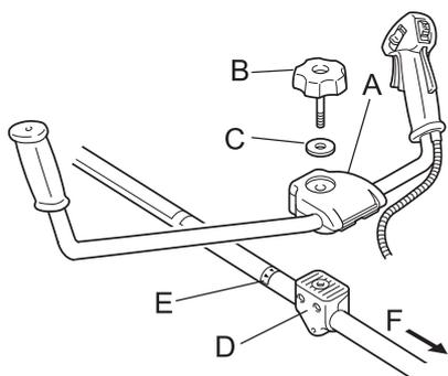
1. Installer le support d'assemblage supérieur (A) du brancard sur le support inférieur (D) et fixer le brancard en serrant légèrement la vis d'assemblage (8 mm) (B).
