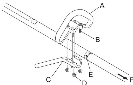
Monter la poignée semi-circulaire (A) et le support (C) sur l'arbre de transmission.
