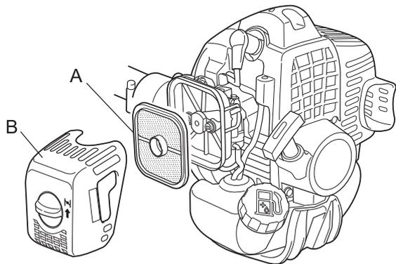
1. Couper le starter. Dévisser le bouton du couvercle de filtre à air et déposer le couvercle du filtre à air (B).
