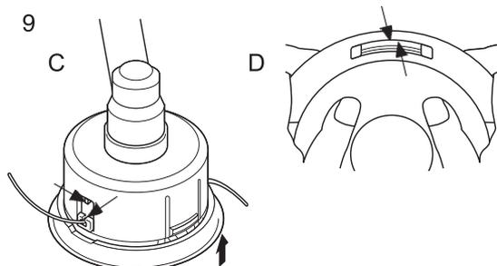
9. Assembler le couvercle et le boîtier. (C) Aligner les « œillets » du couvercle avec les « renforcements » du boîtier, puis (D) enfoncer les ergots du boîtier dans les ouvertures correspondantes du couvercle jusqu'à ce que les ergots s'encastrent parfaitement.
