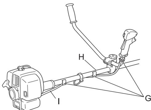
3. Pour éviter le flottement du câble d'accélérateur (I), il faut le fixer au tube de transmission (H) (en 2 endroits) et à la branche de droite du brancard en U (à 1 endroit) à l'aide des colliers de fixation (G).
