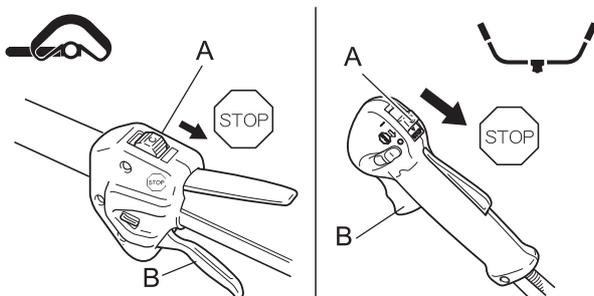
1. Stellen Sie den Gashebel (B) in die Leerlaufposition, und lassen Sie den Motor bei Leerlaufdrehzahl (niedrige Drehzahl) laufen.
