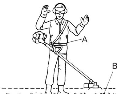
**Gerät so ausbalancieren, dass der Schneidkopf parallel zum Boden steht**
