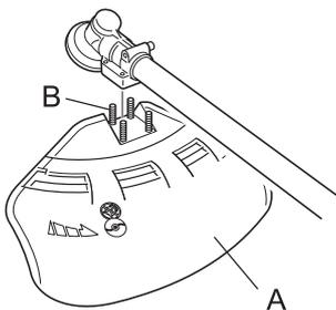
1. Befestigen Sie das Schutzschild (A) am Winkelgetriebe und ziehen Sie die 4 Schrauben (B) fest.
