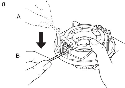
8. Ziehen Sie den Faden aus dem Deckel. Lösen Sie (A) den Faden aus den entsprechenden Schlitzen der Fadenspule, und führen Sie ihn (B) durch die beiden Fadendurchführungen.
