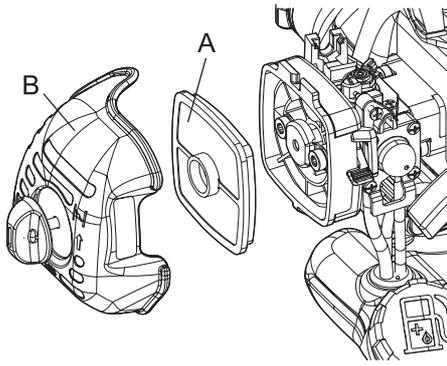
1. Schließen Sie den Choke. Lösen Sie die Verriegelung der Luftfilterabdeckung und entfernen Sie die Luftfilterabdeckung (B).
