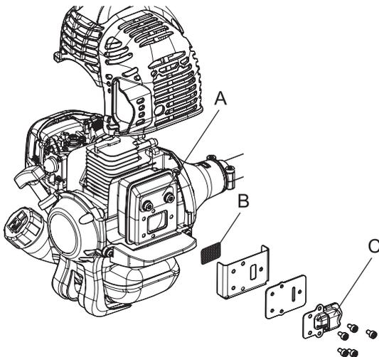
1. Entfernen Sie die Schalldämpferabdeckung.
