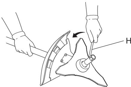
1. Kontrollieren Sie die Messer (C) vor der Montage. Überprüfen Sie die Schärfe. Bei stumpfen Messern erhöht sich das Risiko eines Rückschlags. Kleine Risse können sich zu Brüchen entwickeln, sodass Teile des Messers während des Betriebs weggeschleudert werden. Entsorgen Sie gerissene Messer, egal, wie klein der Riss ist.
