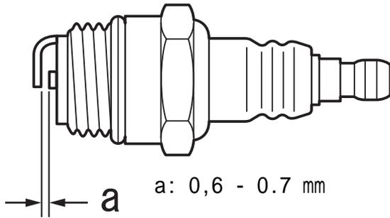
1. Prüfen Sie den Elektrodenabstand. Der korrekte Abstand beträgt 0,6 bis 0,7 mm.
