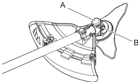
1. Entfernen Sie den Stopfen (B) aus dem Winkelgetriebe (A).
