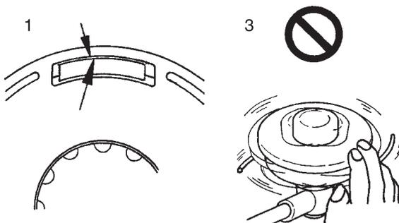
1. Vergewissern Sie sich, dass jeder der 2 Rückhaltstifte des Gehäuses vollständig in die entsprechenden Aussparungen eingerastet ist.
