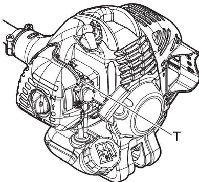
Jedes Gerät wird werkseitig einem Probelauf unterzogen, bei dem der Vergaser auf optimale Leistung eingestellt wird. Reinigen/wechseln Sie vor der Vergaserjustierung den Luftfilter, starten Sie den Motor, und lassen Sie ihn einige Minuten warmlaufen.
