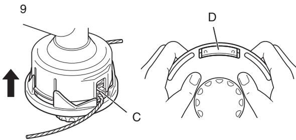
9. Fügen Sie Deckel und Gehäuse zusammen. Ordnen Sie (C) die Fadenösen des Deckels über den Aussparungen in der Fadenspule an, und drücken Sie (D) die beiden Stifte des Gehäuses ganz in die Aussparungen der Fadenspule, bis sie fest in die Fenster einrasten.
