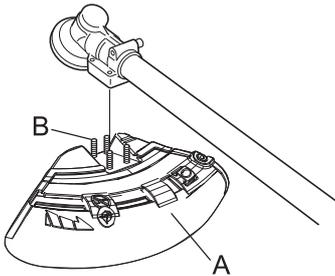
1. Befestigen Sie das Schutzschild (A) am Winkelgetriebe und ziehen Sie die 4 Schrauben (B) fest.
