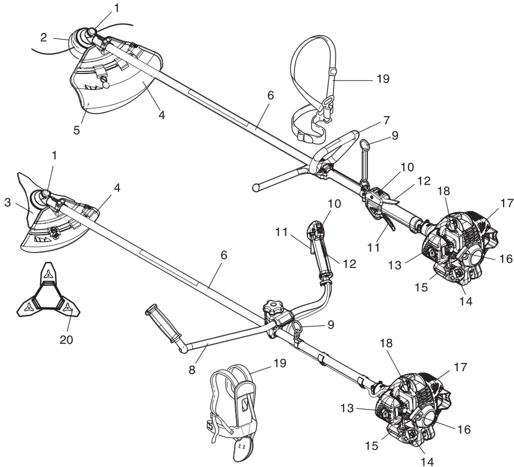
1. **Winkelgetriebe** Ermöglicht es, den Winkel der Rotationsachse zu ändern.
