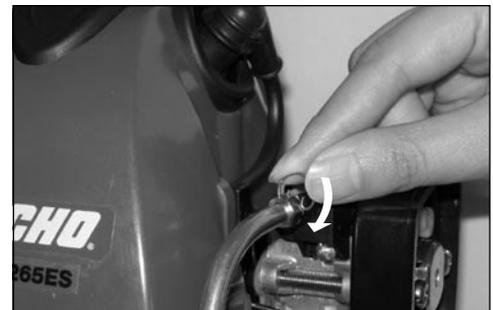
6. Vergewissern Sie sich, dass beide Enden der Klammer, wie in der Zeichnung dargestellt, eingerastet sind. Überzeugen Sie sich dass der Gaszug (B) sich nicht verschiebt wenn der Gasgriff betätigt wird. Überprüfen Sie die Funktion. Drosselklappe muß sich leicht bewegen, ganz öffnen und schließen lassen.
