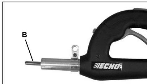
4. Richten Sie das flexible Verbindungselement der Antriebswelle mit dem Steckschlüssel der Antriebswelle aus, und schieben Sie diese so lange zusammen, bis die Griffbaugruppe vollständig in der Antriebswelle sitzt.
