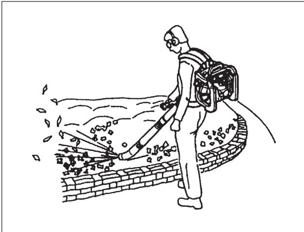
1. Zwecks Beseitigung trockenen Laubs von einem Rasen oder Blumenbeet das Motorgebläse bei niedriger Drehzahl einsetzen.
