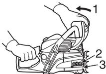
1. Lösen der Kettenbremse
