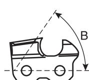
B: Schnittwinkel des Zahndachs K1NK-BL und K2L: 60°; 21BPX und 95VPX: 55°
