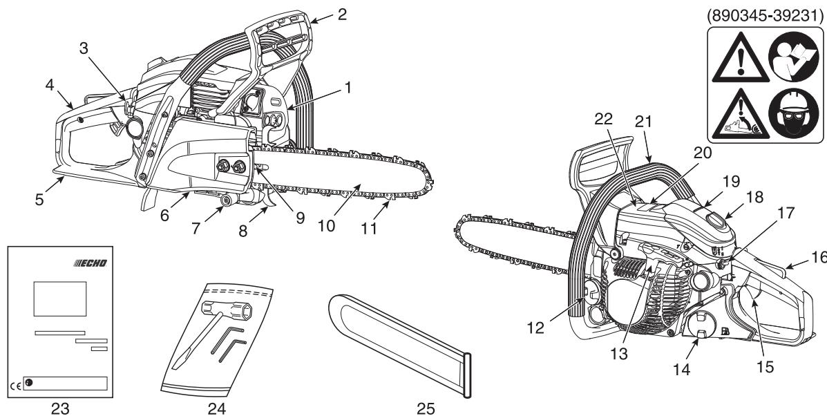
1. **Marmitta** - Controlla la rumorosità dello scarico e impedisce la fuoriuscita di particelle di carbone calde e incandescenti.
