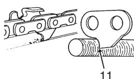
11. La conexión de accionamiento sirve para eliminar el serrín de la ranura de la barra guía. Por lo tanto, mantenga afilado el extremo inferior de la conexión de accionamiento.
