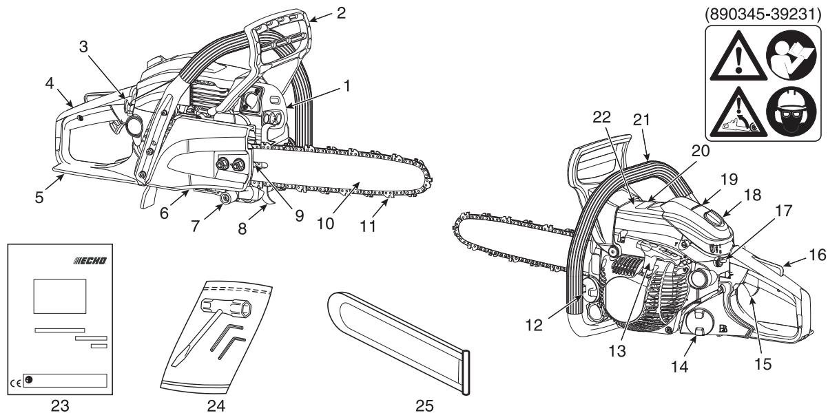
1. **Silencieux** - Le silencieux réduit le bruit de l'échappement et évite la projection de particules de carbone incandescentes hors du silencieux.
