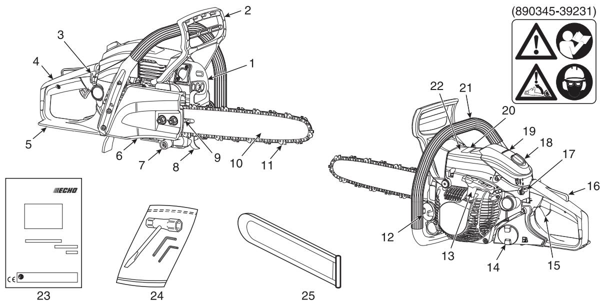
1. **Schalldämpfer** - Der Schalldämpfer dient zur Senkung des Auspuffflärms und verhindert, dass glühende Kohlenstoffpartikel aus dem Schalldämpfer austreten.
