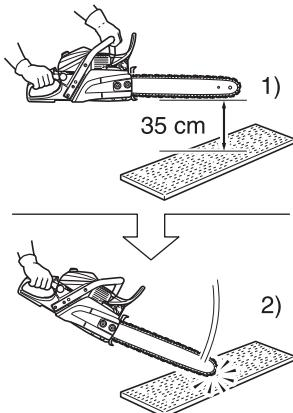
El freno de cadena no manual detiene el funcionamiento de la cadena de la sierra de tal modo que la acción de retroceso provocada por el extremo de la barra guía activa de forma no manual el freno de cadena.
