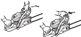
1. Bloquee la cadena: presione la protección para la mano delantera hacia adelante.
