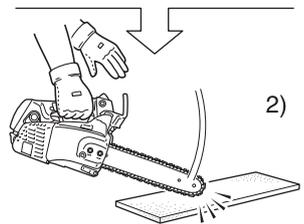
Die automatische Kettenbremse stoppt den Betrieb der Motorsäge derart, dass die am Ende der Kettenschiene erzeugte Rückschlagwirkung automatisch die Kettenbremse betätigt. Gehen Sie auf folgende Weise vor, um sicherzustellen, dass die automatische Kettenbremse richtig funktioniert:
