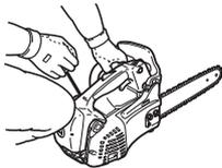
Nach dem Stellen des Steuerhebels in die Position „Kaltstart“ und anschließendem Zurückstellen in die Position „Warmstart“ verbleibt der Gashebel in einer leicht erhöhten Leerlaufeinstellung.
