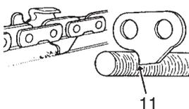
11. Das Treibglied dient zur Beseitigung von Sägestaub aus der Nut der Führungsschiene.
