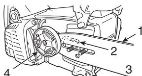
1. Nut      2. Ölbohrung      3. Führungsschiene      4. Kettenrad
