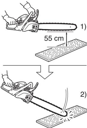
Die automatische Kettenbremse stoppt den Betrieb der Motorsäge derart, dass die am Ende der Kettenschiene erzeugte Rückschlagwirkung automatisch die Kettenbremse betätigt. Gehen Sie auf folgende Weise vor, um sicherzustellen, dass die automatische Kettenbremse richtig funktioniert:
