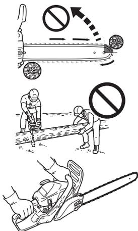
Eine Motorsäge darf immer nur von einer Person bedient werden.
