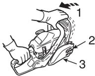
1. Lösen der Kettenbremse
