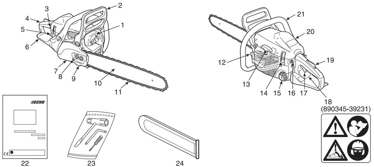
1. **Schalldämpfer** - Der Schalldämpfer dient zur Senkung des Auspufflärms und verhindert, dass glühende Kohlenstoffpartikel aus dem Schalldämpfer austreten.
