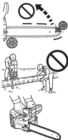
Eine Motorsäge darf immer nur von einer Person bedient werden.
