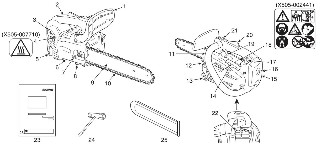
1. **Vorderer Handschutz** - Schutz zwischen vorderem Handgriff und der Sägekette, um die Hand vor Verletzungen zu schützen und die Maschine zu kontrollieren, wenn die Hand vom Griff abrutscht. Dieser Schutz wird verwendet, um die Kettenbremse zu aktivieren und die Kettenrotation zu stoppen.
