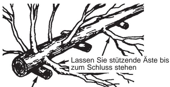
Stützende Aststümpfe befinden sich unter dem Stamm
