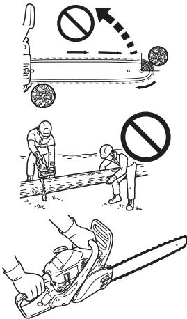
Eine Motorsäge darf immer nur von einer Person bedient werden.
