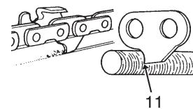
Nach dem Schärfen ist die Kette in Öl zu legen und verbleibender Feilstaub vor dem Einsatz ganz zu entfernen.
