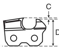
C: Calibro di profondità N1C-BL; 0,56 mm, 91PX, 91VG, 91VXL, 91VX, 90PX e 90SG; 0,65 mm
