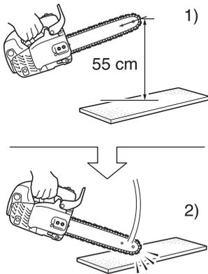
Die automatische Kettenbremse stoppt den Betrieb der Motorsäge derart, dass die am Ende der Kettenschiene erzeugte Rückschlagwirkung automatisch die Kettenbremse betätigt. Gehen Sie auf folgende Weise vor, um sicherzustellen, dass die automatische Kettenbremse richtig funktioniert:
