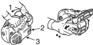
1. Lösen der Kettenbremse
