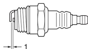
1. Elektrodenabstand: 0,6 bis 0,7 mm
