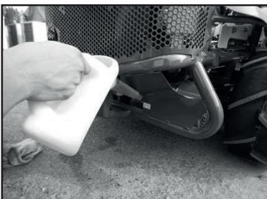
2) Montieren Sie die Ablassschraube in die ursprüngliche Position. Entfernen Sie die Verschlusschraube und füllen Sie dann Getriebeöl ein.
